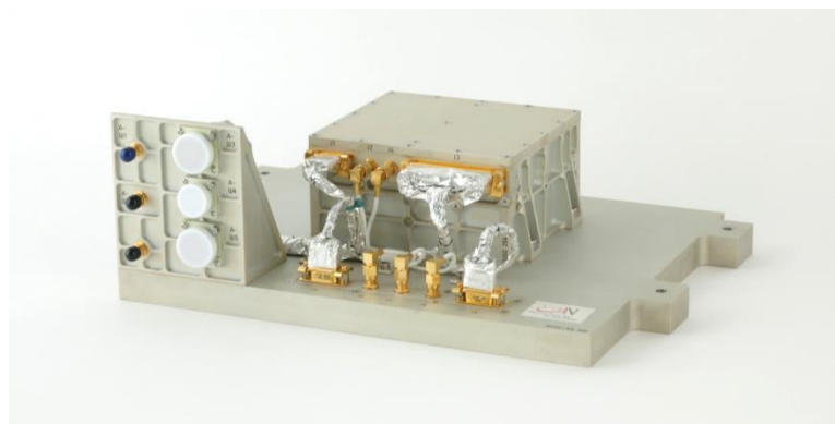
Im Observatorium Neuenburg entwickelte Rubidium-Atomuhr für die Europäische Weltraumorganisation zwischen 1989 und 1994. Die Uhr fliegt seit 2011 auf der russischen Weltraummission RadioAstron CSEM, Neuenburg
